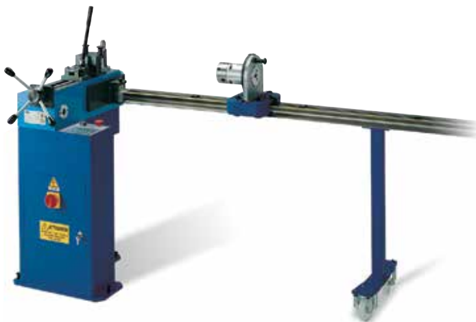
Digitale UNI70/C in der Ausführung mit dem Rohrhalteam.
