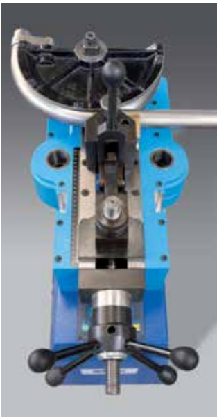
UNI 60 COMBI während einer Rohrbiegung
