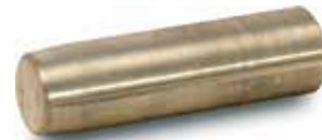
Fester Dorn (ein für jeden \varnothing , Radius und Wandstärke) für Radien, die entsprechend und/ oder grösser sind als 2,5D und die Wandstärke über 2mm haben. Der Dorn hat eine Längsnure zum Einführen der Rohrschweissung.
