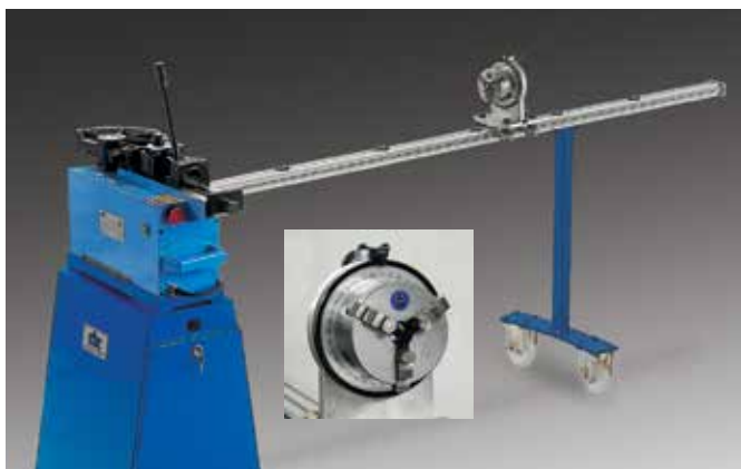
UNI42A in der kompletten Ausführung mit Rohrhalteam und Unterschrank.
