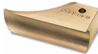
Anfaltenstück (ein für jeden \varnothing und Radius) für dünnwandige und zarte Rohre. Es vermeidet Kratzer auf der Rohrinnenoberfläche und wird zusammen mit der Gleitschiene benutzt.
