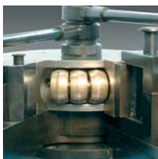
Kugeldorn während der Biegung.
