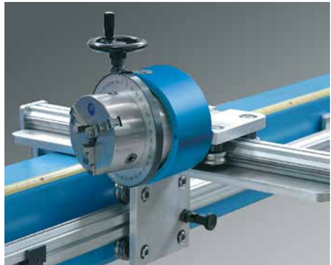
Einzelheit der speziellen schwingenden Spindel zum dornlosen Biegen.
