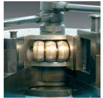
Kugeldorn während der Biegung.
