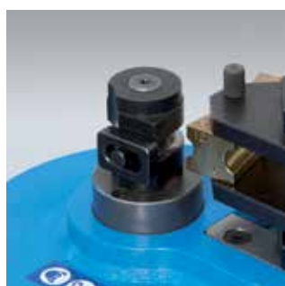
Kleinere Welle zum Biegen von Radien unter 30mm.
