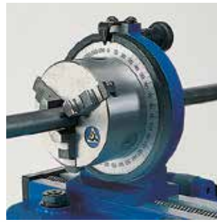
Mechanische Positionierungsspindel der Einstellung der Biegungsebene.
