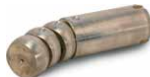
Kugeldorn (ein für jeden \varnothing , Radius und Wandstärke) für Radien, die kleiner sind als 2,5D und die Wandstärke unter 2mm haben. Ideal für sehr dünnwandige Rohre und 2D-Radien.
