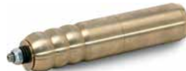
Gelenkiger Dorn (ein für jeden \varnothing , Radius und Wandstärke) für Radien, die kleiner sind als 2,5D und die Wandstärke unter 2mm haben.
