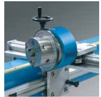
Einzelheit der speziellen schwingenden Spindel zum dornlosen Biegen.
