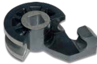
Sphärogussbiegesegment mit Haken Typ G (mm-, WHT-Zoll- und GAS-Zoll-Durchmesser) zu benutzen zum dornlosen Biegen von ST37-Stahl, Edelstahl-, hartem und weichem Kupfer, Aluminium-, weichem Messingrohren. Die von uns empfohlenen minimalen Wandstärken sind zu beachten. Mit Biegeschienen oder Rollen benutzen.
